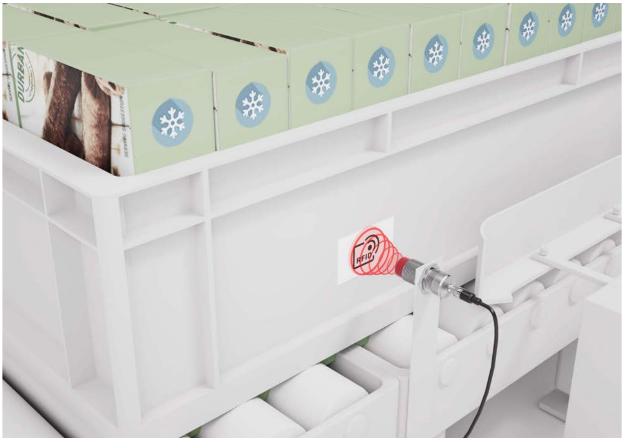
Bild 5.1: Identifikation von Behältern an einer Förderstrecke
