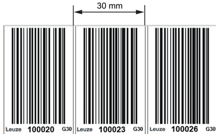
Bild 6.11: Beispiel: Maß 30 mm am selbstgedruckten online-Reparatur-Barcodeband prüfen
