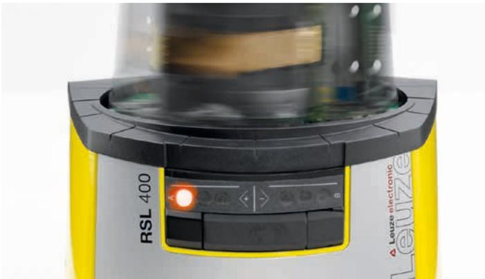
Beim RSL 400 rotiert das gesamte Sende- / Empfangssystem. Dadurch wird ein besonders schmaler und gleichmäßiger Laserspot über den gesamten Scanbereich erzeugt, der Basis für die hohe Winkelauflösung von 0,1 Grad ist (etwa 3x höhere Abtastung als bei konventionellen Scannern).
