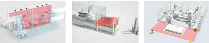
Sicherheits-Lösungen, z. B. zur Sicherung von Übergabestationen und Zugängen an Transportanlagen
