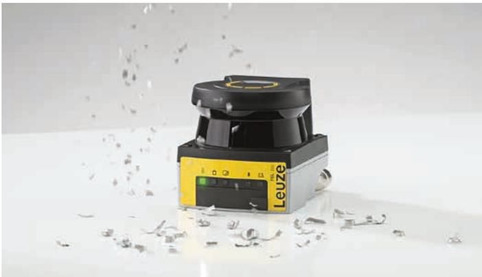
Der RSL 200 filtert nicht sicherheitsrelevante Objekte wie Staub und Partikel in der Luft sehr gut aus. Mit der eingesetzten LiDar-Technologie und der dadurch reduzierten Masse sind die RSL 200 darüber hinaus robust gegen Vibrationen und Schock. So werden unnötige Abschaltungen reduziert.
