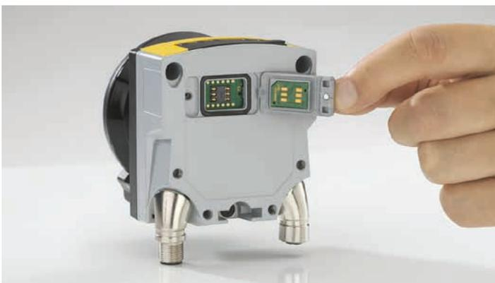
Die RSL 200 verfügen über einen wechselbaren Konfigurationsspeicher. So lässt sich im Servicefall die Gerätekonfiguration schnell und einfach auf ein neues Gerät übertragen.
