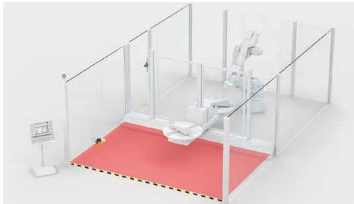
**Lösung:** Die RSL 200 / 400 erkennen den Zugang und die Anwesenheit von Personen im überwachten Bereich. Das konfigurierbare Schutzfeld lässt sich einfach an die Größe des zu sichernden Bereichs anpassen. Der RSL 400 sichert durch seine große Reichweite sogar Bereiche bis zu 160 m<sup>2</sup> mit nur einem Gerät.
