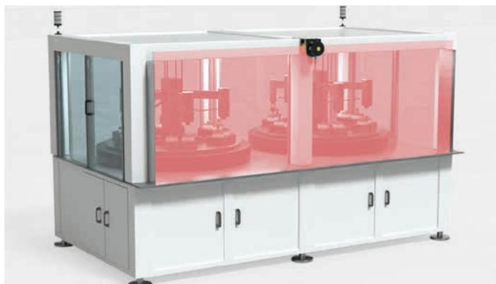
**Lösung:** Der RSL 400 wird oberhalb der Maschinenöffnung installiert und das Schutzfeld vertikal ausgerichtet. Als Sicherheits-Auflösung wird 40 mm (Handerkennung) ausgewählt. Der RSL 400 überwacht seine korrekte Ausrichtung anhand einer Referenzkontur. So werden mögliche Sicherheitslücken durch unbeabsichtigte Veränderungen vermieden.
