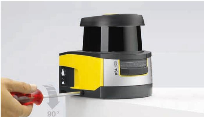
Die Anschlusseinheit des RSL 400 ist abnehmbar und kann separat montiert werden. So bleibt der Scannerkopf geschützt und kann anschließend einfach aufgesetzt werden. Im Servicefall ist der Scanner in weniger als 30 Sekunden ausgewechselt: Zwei Schrauben um 90 Grad drehen und der Scannerkopf kann getauscht werden. Ohne Neuausrichtung, Nachjustage und Konfigurationsaufwand, denn der Konfigurationsspeicher ist in die Anschlusseinheit integriert.
