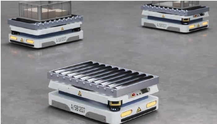
Mit ihren geringen Abmessungen von 80 x 80 x 86 mm (B x H x T) eignen sich die RSL 200 ideal für die Sicherung kompakter Fahrzeuge. Die Geräte verfügen über einen Scanwinkel von 275°. So lassen sich Fahrzeuge mit zwei Scannern rundum komplett sichern.
