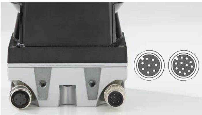
Der Anschluss der RSL 200 erfolgt über einen Standard-M12-Stecker, je nach Funktionalität der Geräte in 8- oder 12-poliger Ausführung. Alle Funktionen, einschließlich der Schutzfeldumschaltung, lassen sich über diesen Anschluss steuern und auswerten. So sind die RSL 200 besonders einfach integrierbar.
