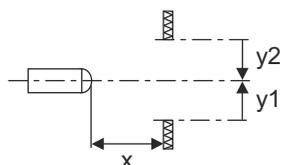
Comportamento di risposta tip. con 90% di remissione (distanza di regolazione 400 mm)
