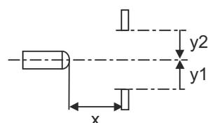
Réaction typ. (distance de réglage 800 mm)
