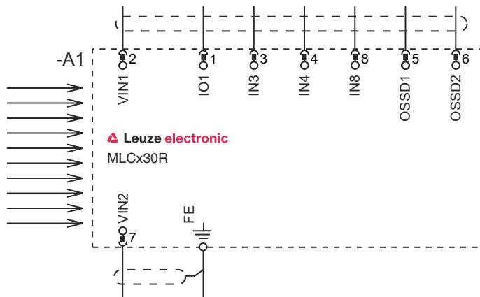
Betriebsart 1: Schaltungsbeispiel zur Verkettung mit Positionsschalter zur Überwachung der Anwesenheit von fest ausgeblendeten Maschinenteilen
