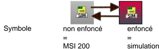
Figure 5-19 Symbole « Simuler le contrôleur de sécurité configurable »
