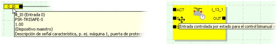
Figura 2-9 Ejemplos de informaciones sobre herramientas del editor de circuitos en el modo sin conexión a la red (durante la edición de la lógica de seguridad)
