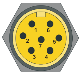
Fig. 7.4-2: Interface machine /T3, connecteur MIN-Series (vue sur les broches)
