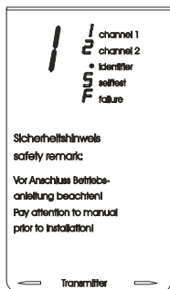
Fig. 5.1-1: Signalisation d'état de l'émetteur
