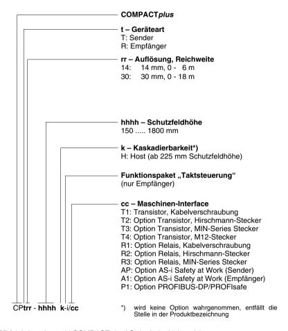
Bild 1.3-1: Auswahl COMPACT plus-i Sicherheits-Lichtvorhänge
