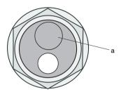
a = Öffnung nur durchstoßen, wenn separates Anschlusskabel für den Lastkreis angeschlossen
