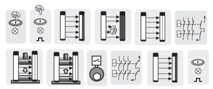
Bild 4.2-4: Funktionsablauf Eintakt-Betrieb
