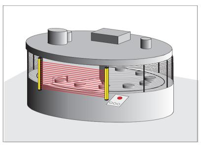
Bild 3.3-2: Rundtakt-Tisch mit Handbestückung und -entnahme
