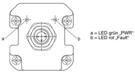
Bild 7.9-4: Empfänger-Anschlusskappe mit LEDs
