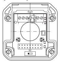
Bild 7.2-1: Sender-Anschlusskappe /T1 abgezogen, Innenansicht/Klemmenfeld
