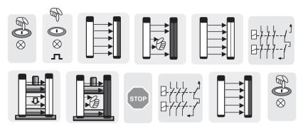
Bild 4.2-5: Eintakt-Betrieb. Nachgreifen während der Maschinenbewegung
