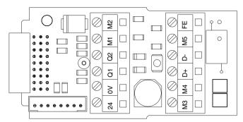
Bild 7.2-3: Empfänger Maschinen-Interface /T1, Klemmenfeld
