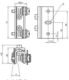
a = Langloch 13 x 6 $b = Schwenkbereich \pm 8^{\circ}$
