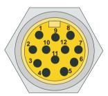
**Bild 7.8-1:** Empfänger Maschinen-Interface /R3, MIN-Series Stecker (Blick auf die Stifte)
