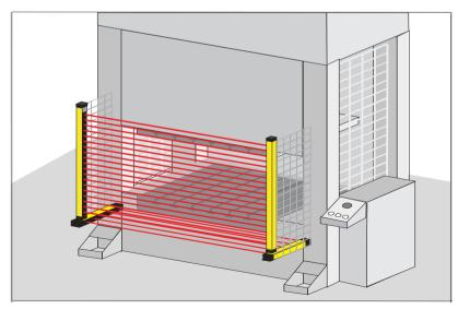
Bild 3.3-1: Hydraulische Presse im Schutz-, Eintakt- oder Zweitakt-Betrieb
