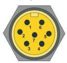
Bild 7.4-2: Maschinen-Interface /T3, MIN-Series (Blick auf die Stifte)
