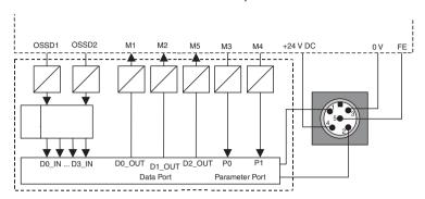
Bild 7.9-5: Maschinen-Interface /A1, schematischer Aufbau
