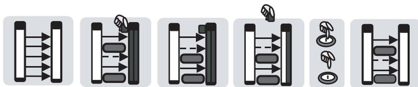
**Fig. 4.3-6:** Apprentissage simultané d'une zone de suppression fixe et, après sélection avec S4/S5, d'une zone flottante
