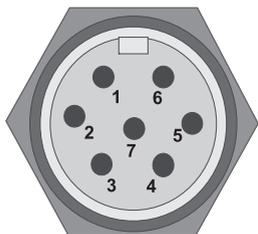
**Fig. 7.4-2:** Récepteur interface machine /T3, connecteur MIN-Series à 7-points (vue sur les broches)
