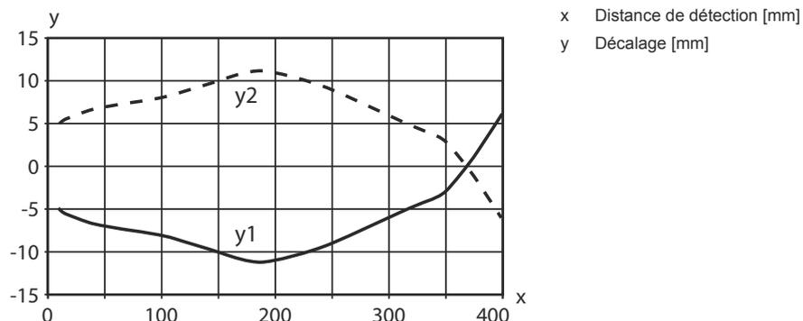
Réaction typ. (distance de réglage 1200 mm)
