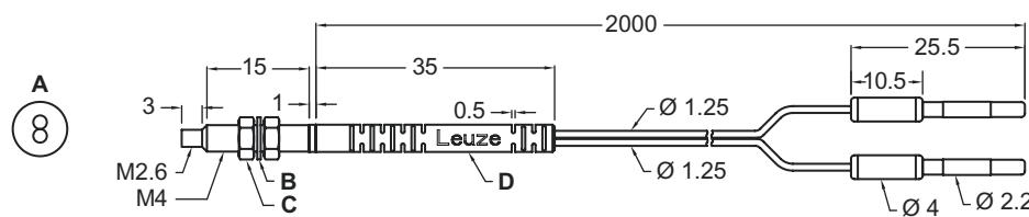
A Ø 0,5 mm núcleo de fibra sintética x 2 pç.
