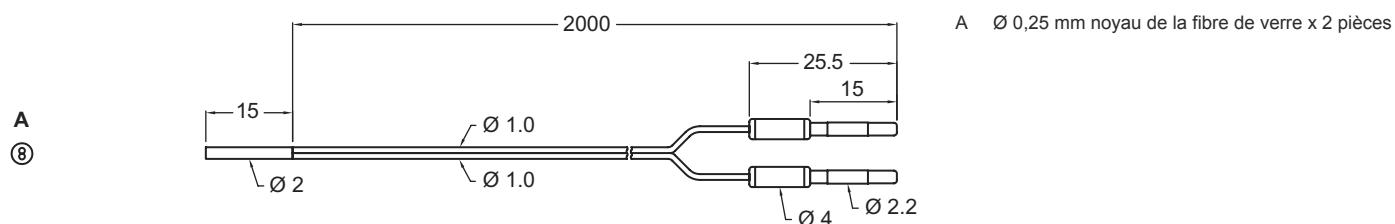
A Ø 0,25 mm noyau de la fibre de verre x 2 pièces
