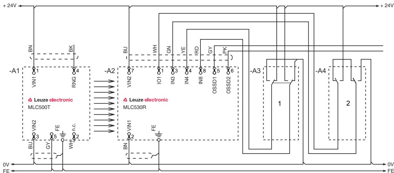
1 Wechselschlüsselschalter zum Umschalten zwischen den Funktionsgruppen FG1 und FG2
