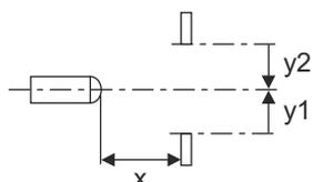
Réaction typ. (distance de réglage 1200 mm)
