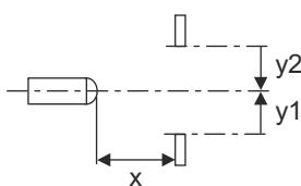
Comportamento di risposta tip. con 90% di remissione (distanza di regolazione 400 mm)
