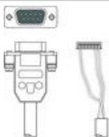
50113397 | KB JST-HS-300 | Cabo de ligação | Adequado para interface: RS 232<br>Conexão 1: JST ZHR<br>Conexão 2: Sub-D, Axial, male, 9 polos<br>Blindado: Sim<br>Comprimento do cabo: 300 mm<br>Material da bainha: PUR |
