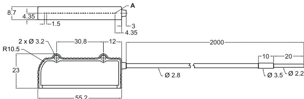
A Ø 0,265 mm núcleo de fibra de vidro x 32 pç.
