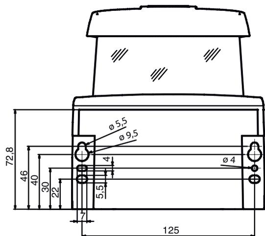
Espacio mínimo requerido para el montaje y la sustitución del escáner
