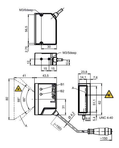
A Haz láserB1 LED decod.B2 LED de estado
