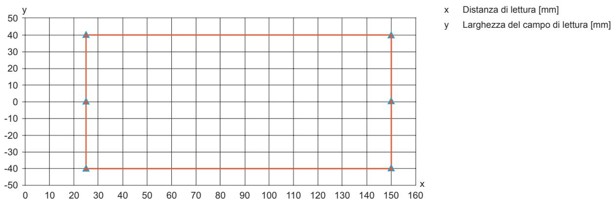
Curva del campo di lettura per modulo  $m = 0,2 \dots 0,5 \text{ mm}$  (8 ... 20 mil)
