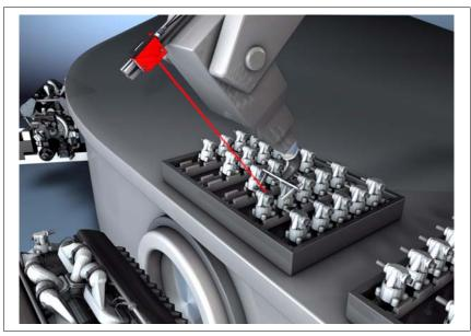
그림 5.4: 사용 예시 : ODSL 96B "S"(TRI) 를 이용한 로봇팔 위치 제어
