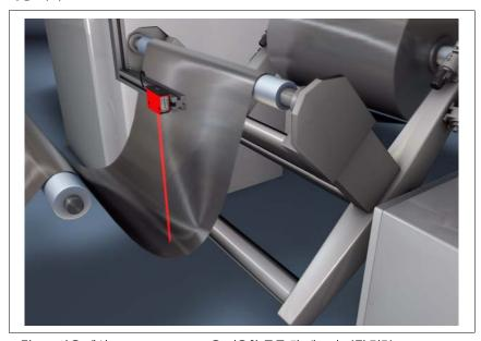
그림 5.6: 사용 예시 : ODSL 96B (TOF) 을 이용한 돌돌 만 재료의 처짐 점검
