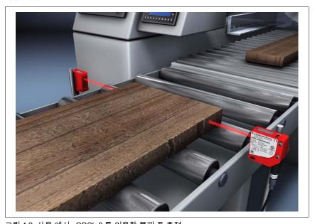
그림 4.2: 사용 예시 : ODSL 9 를 이용한 목재 폭 측정
