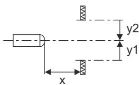
Comportamento di risposta tip. (distanza di regolazione 500 mm)
