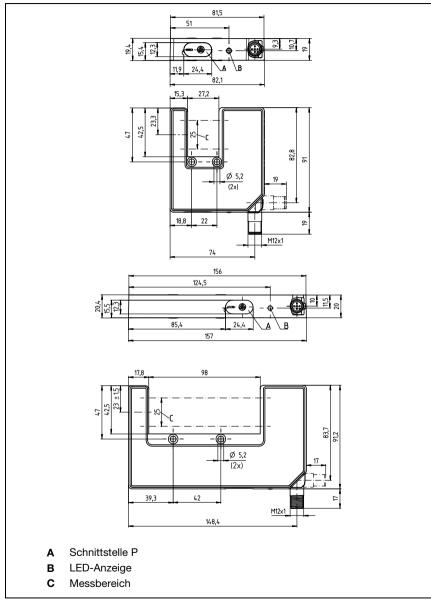
Bild 3.1: Lage der Bedien- und Anzeigeelemente
