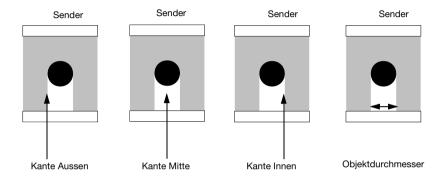
Bild 6.2: Umschaltung der Kantenzuordnung bei 1-Objekt-Messung
