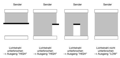
Bild 6.8: Funktion Lichtschranke dunkelschaltend
