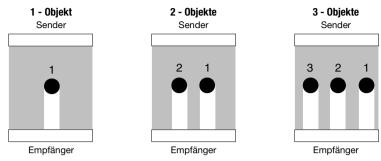
Bild 5.2: Durchmesserermittlung - Erkennung von 1, 2 oder 3 Objekten
