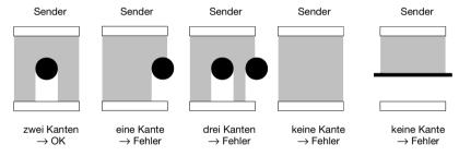
Bild 6.6: Beispiel Durchmessererkennung
