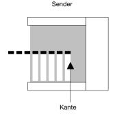
Bild 6.1: Kantenmessung bei durchbrochenen Objekten
