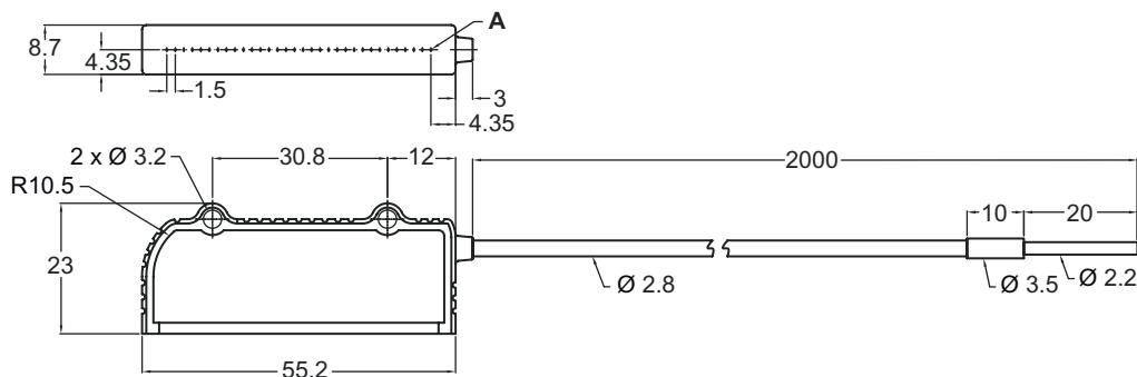
A Ø 0,265 mm noyau de la fibre de verre x 32 pièces
