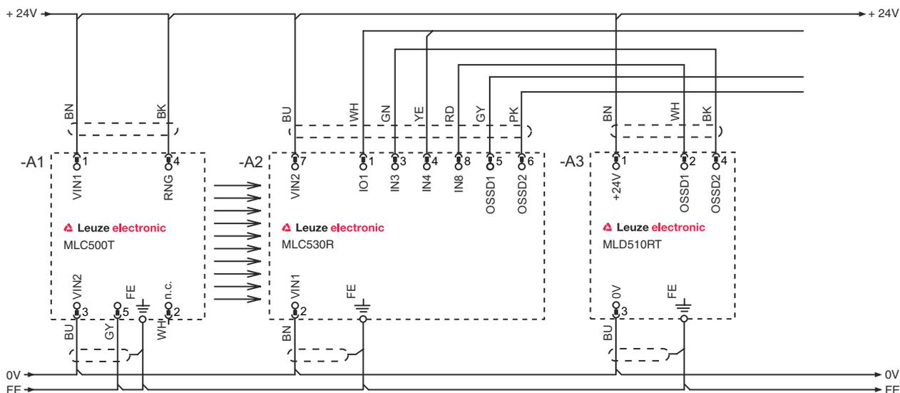
Modo operativo 3: esempio di circuito di un interruttore di posizione concatenato a contatto per il monitoraggio di oggetti oscurati ed un commutatore per la commutazione tra i gruppi di funzioni FG1 e FG2
