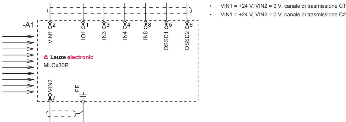
Modo operativo 1: esempio di circuito per la concatenazione con interruttore di posizione per il monitoraggio della presenza di parti della macchina oscurate in modo fisso
