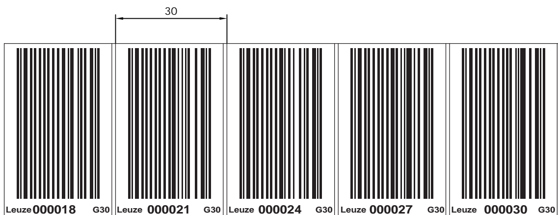
Figura 12.2: Verifica del risultato di stampa del kit di riparazione BCB G30 ... (reticolo da 30 mm)
