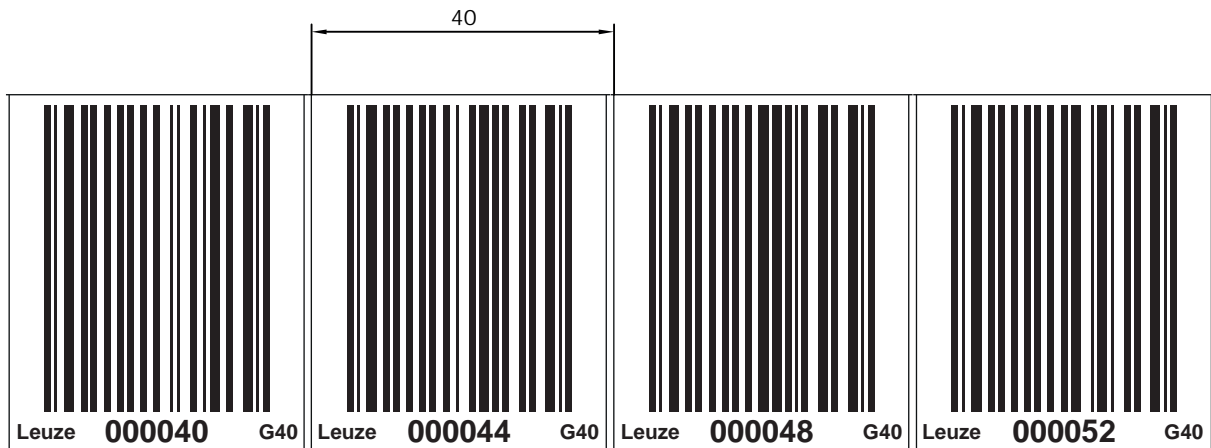
Figura 12.1: Comprobar el resultado de impresión del kit de reparación BCB G40 ... (raster de 40 mm)
