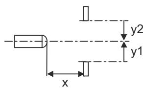
Comportamento di risposta tip. (distanza di regolazione 600 mm)
