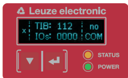
Figure 3.6 : Touches de fonction sur le récepteur
