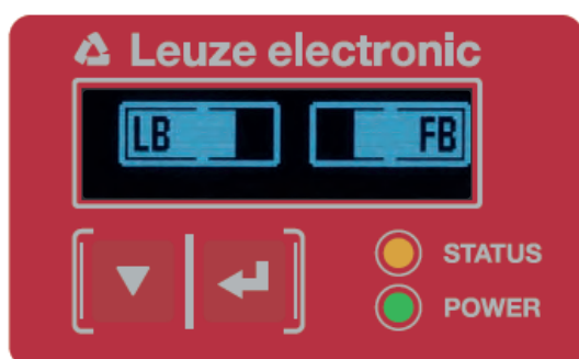
Figure 8.2 : Représentation à l'écran d'un rideau lumineux aligné de façon optimale
