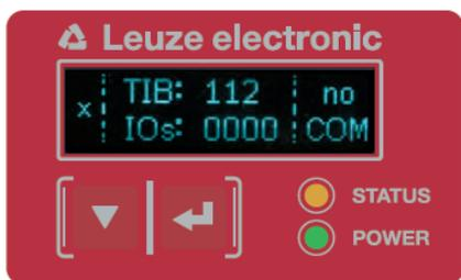
Figura 3.6: Tasti funzione sul ricevitore
