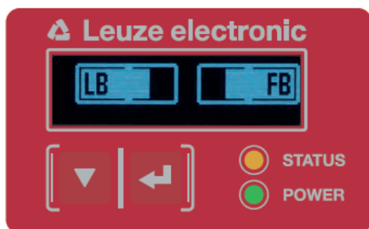
Fig. 8.4: Representación del display después de un Teach realizado con éxito
