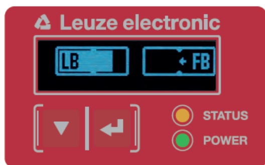
Fig. 8.1: Ejemplo: Visualización en display de una cortina óptica con alineación incorrecta
