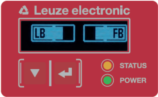
Figura 8.2: Rappresentazione display di una cortina fotoelettrica allineata in modo ottimale
