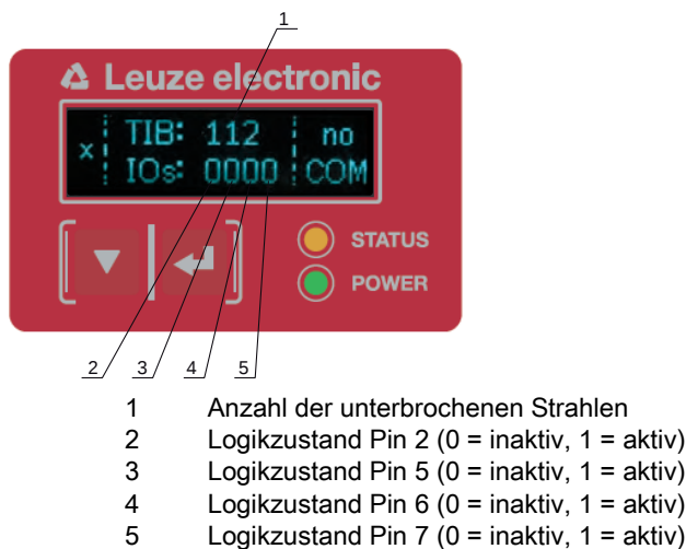
Bild 3.5: OLED-Display am Empfänger im Prozessbetrieb
