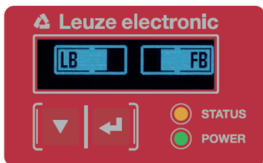
Bild 8.2: Displaydarstellung eines optimal ausgerichteten Lichtvorhangs
