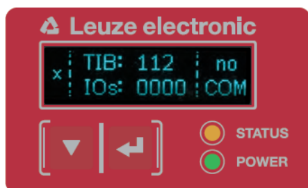
Bild 8.3: Displaydarstellung des Prozessbetriebszustands des Lichtvorhangs
