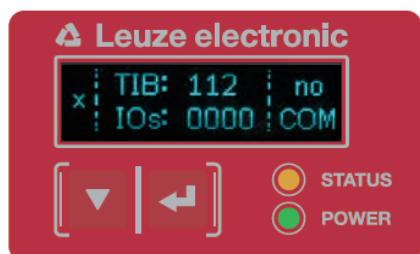
Bild 3.7: Funktionstasten am Empfänger
