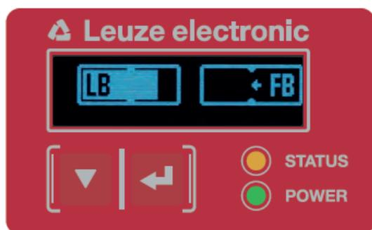
Figure 8.1 : Exemple : Représentation à l'écran d'un rideau lumineux mal aligné
