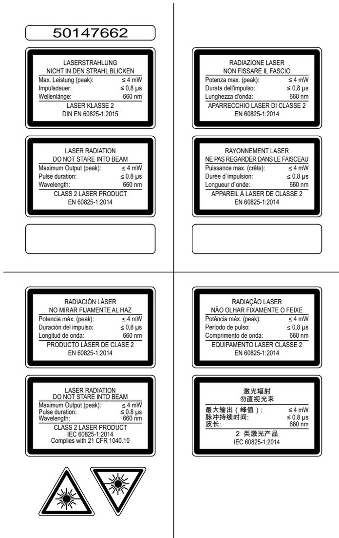
그림 2.2: 레이저 경고 라벨 및 레이저 주의 사항 라벨 - 동봉된 스티커
