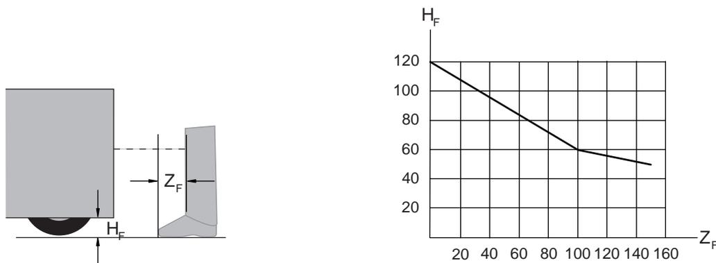
Figura 7.15: Diagrama para la determinación del suplemento  $Z_F$  cuando no hay suficiente altura sobre el suelo  $H_F$
