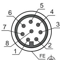
Figura 8.1: Asignación de pines del sensor de seguridad
