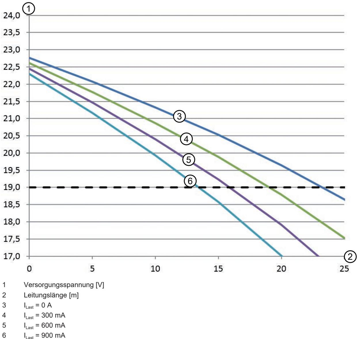
Bild 8.4: Diagramm zur Abschätzung Spannungsabfall auf Versorgungsleitung
