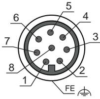
Bild 8.1: Anschlussbelegung Sicherheits-Sensor
