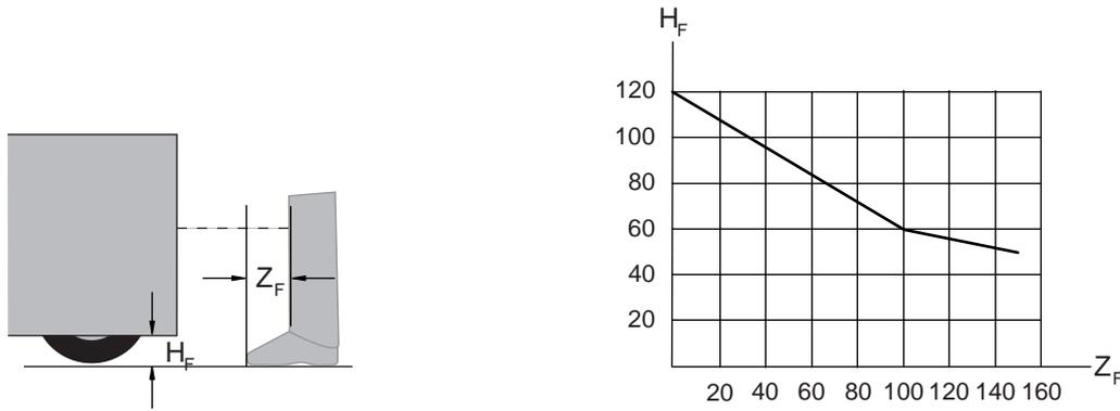
Bild 7.15: Diagramm zur Bestimmung des Zuschlags  $Z_F$  bei mangelnder Bodenfreiheit  $H_F$ . Bei einer Fahrzeughöhe von weniger als 50 mm ist immer ein Zuschlag  $Z_F$  von 150 mm notwendig. Wenn Räder nahe der Seitenwand montiert sind, addieren Sie in jedem Fall einen Zuschlag  $Z_F > 150$  mm.
