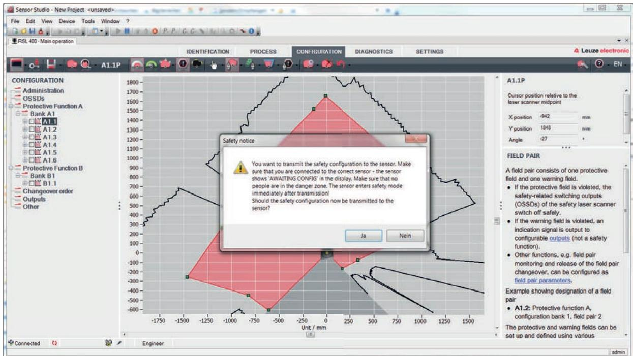
Bild 9.3: Kontrolle vor dem Herunterladen der Sicherheits-Konfiguration
