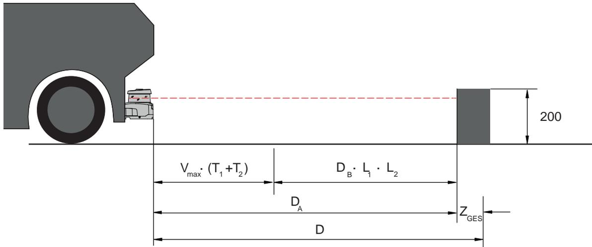
Bild 7.14: Mobile Gefahrbereichssicherung, Berechnung der erforderlichen Mindestdistanz D
