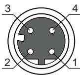
Bild 8.2: Anschlussbelegung Ethernet-Schnittstelle
