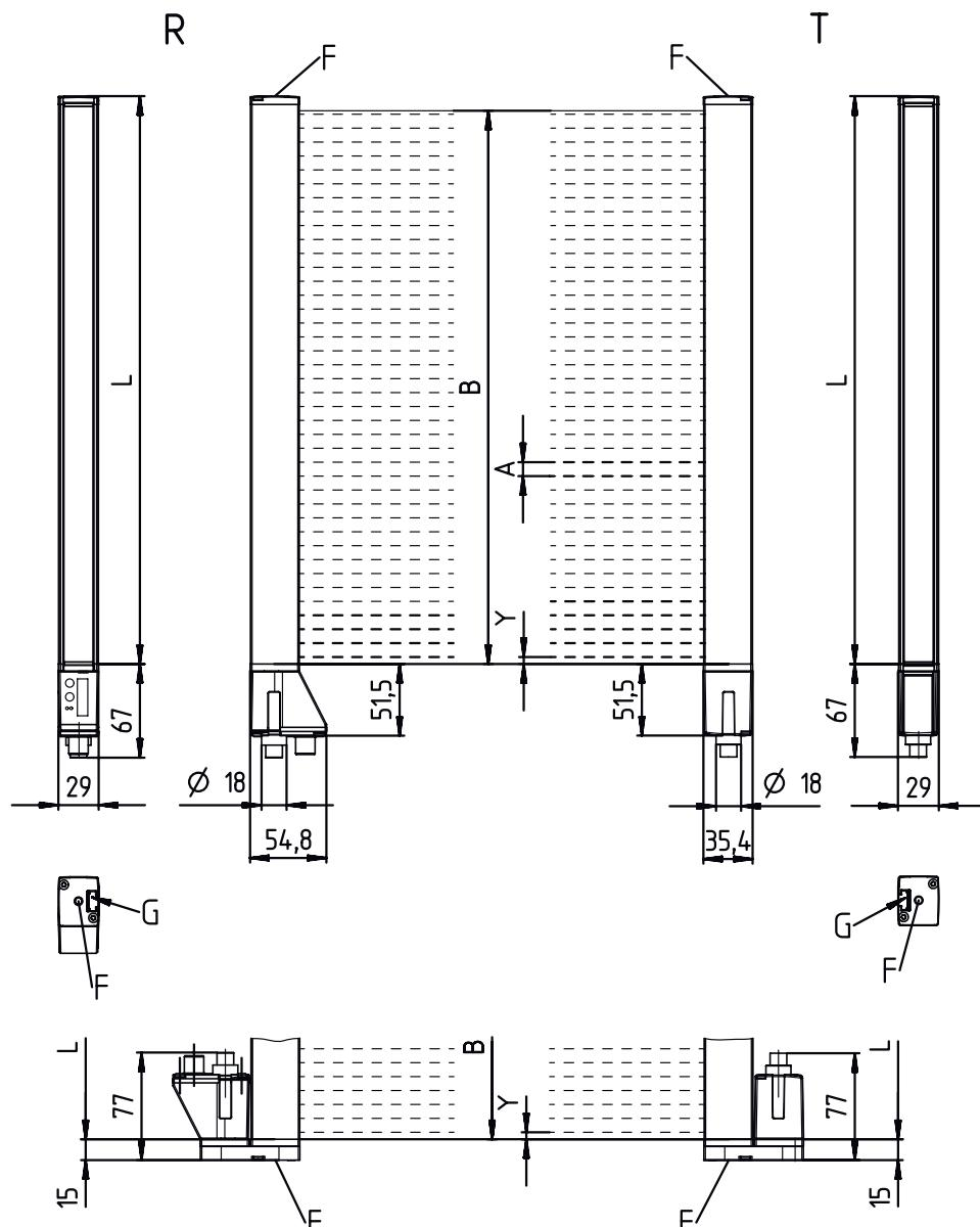
A Intervalle entre les faisceaux 20 mm
