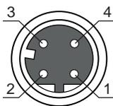
Figura 8.2: Assegnazione dei pin dell'interfaccia Ethernet
