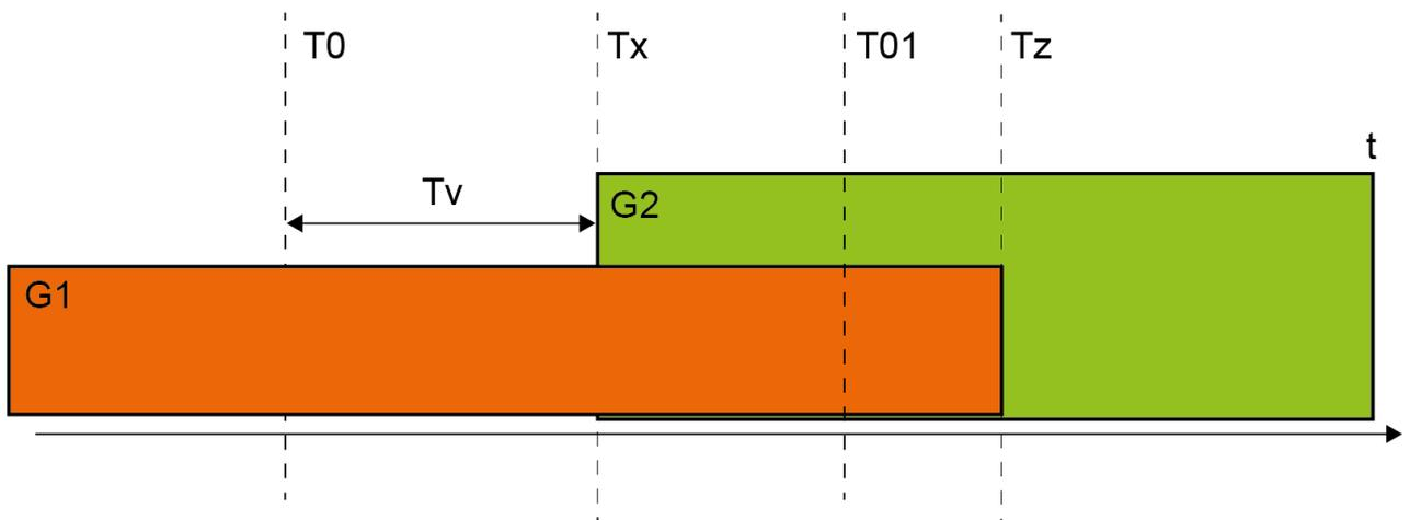
Figura 5.13: Commutazione delle coppie di campi con 2 punti pericolosi
