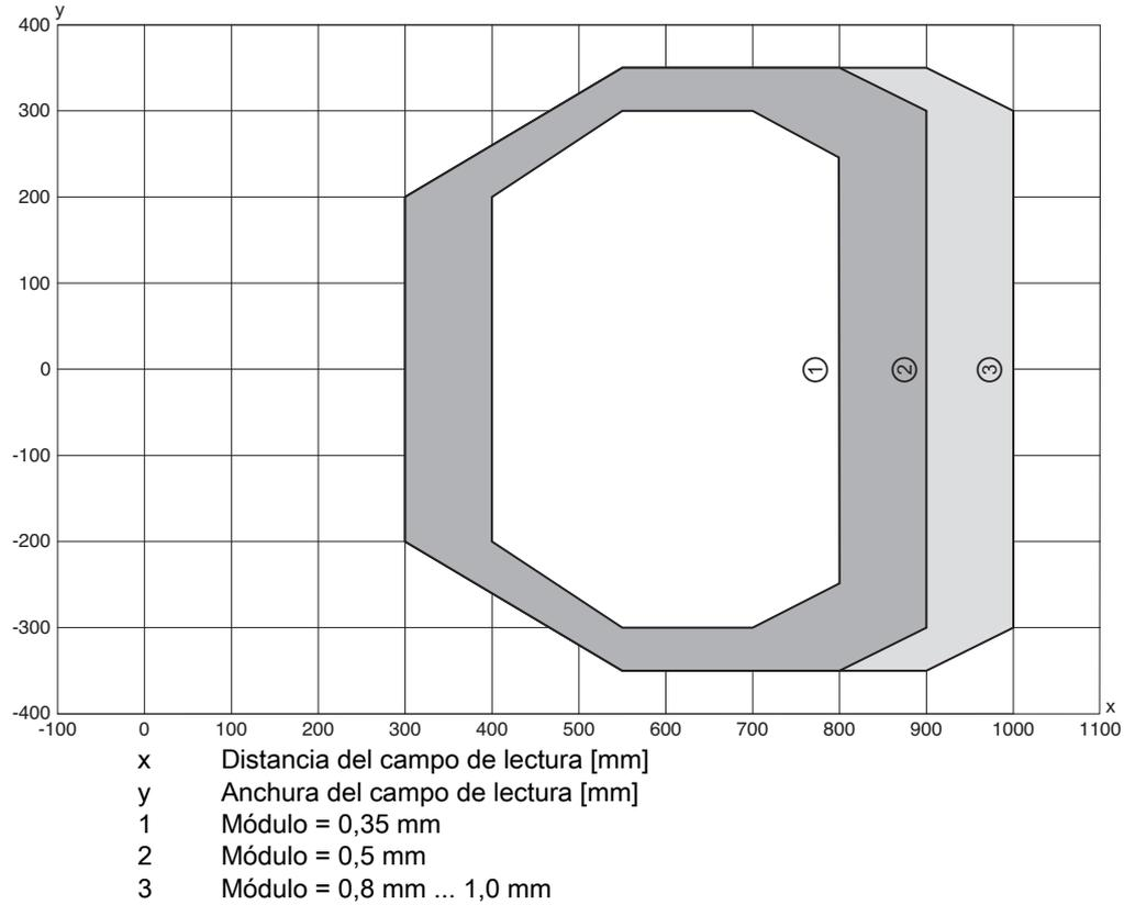
Fig. 15.23: Curva del campo de lectura «Medium Density» para escáner lineal con calefacción
