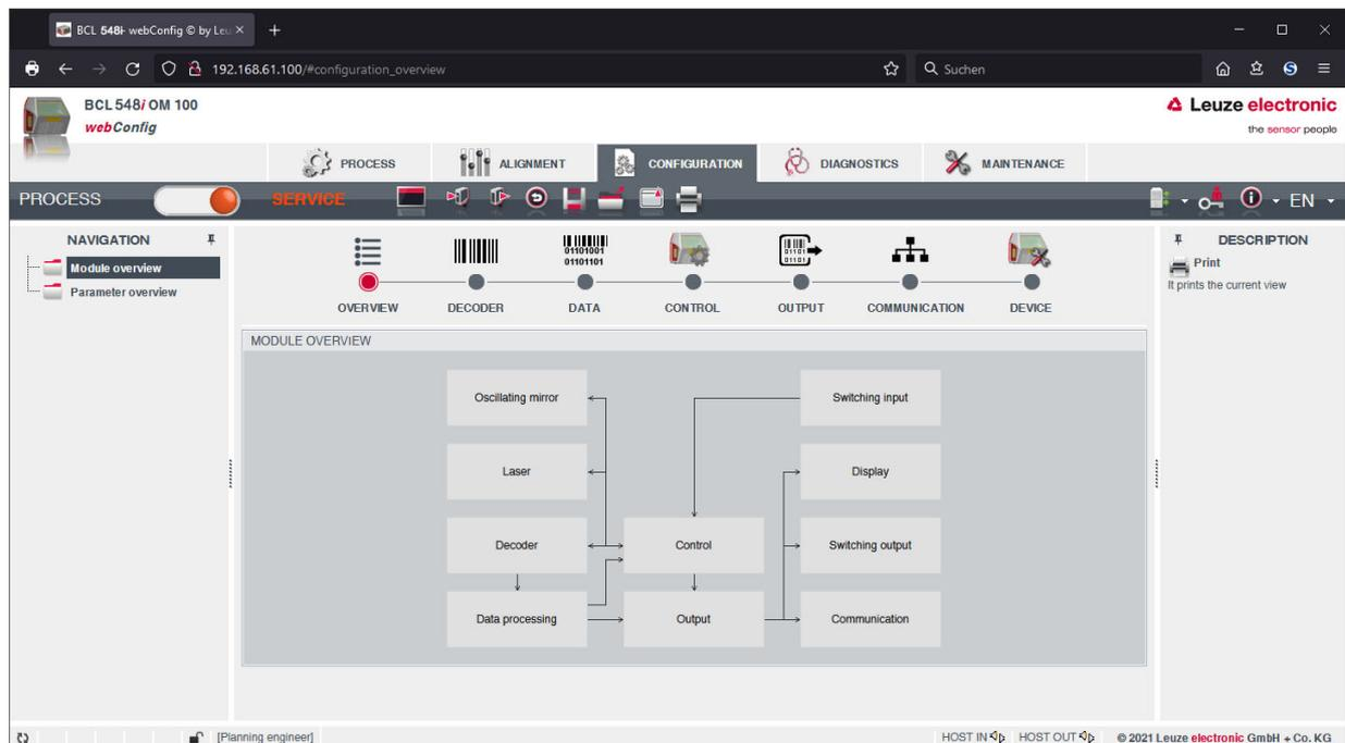
Fig. 9.2: Vista general de los módulos en la herramienta webConfig
