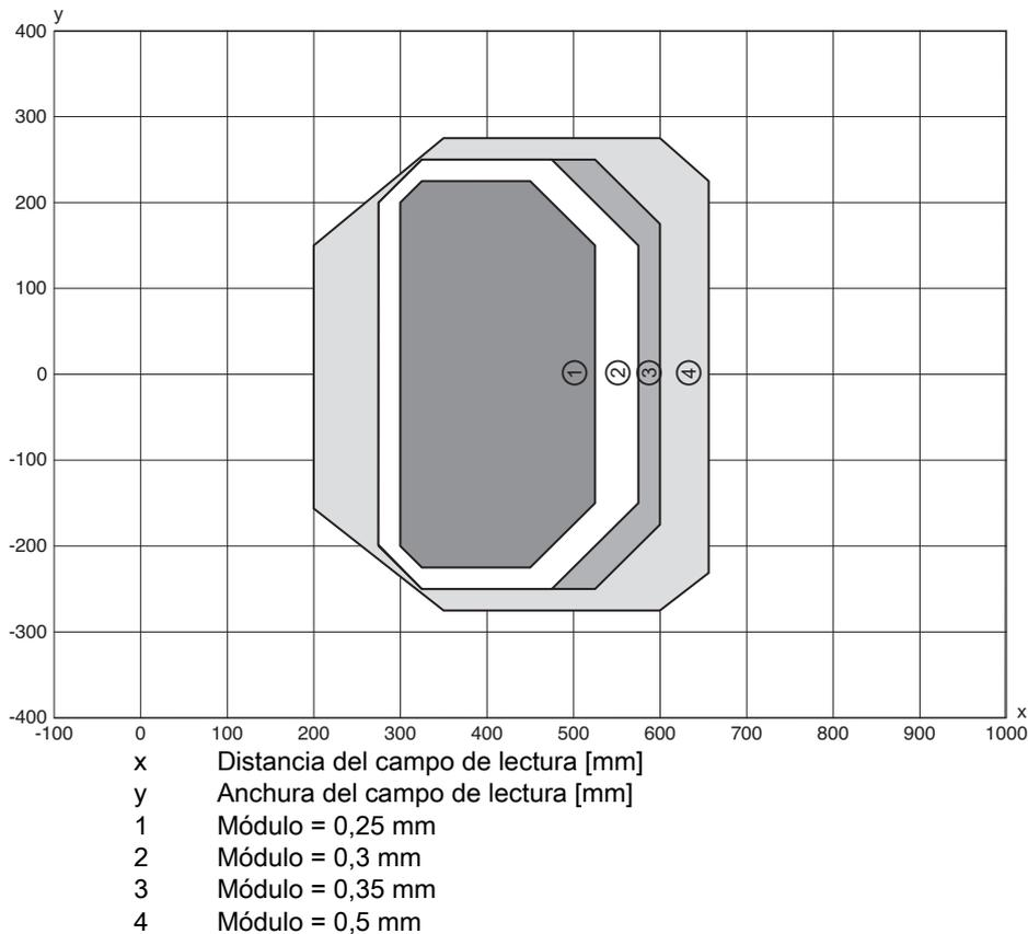
Fig. 15.20: Curva del campo de lectura «High Density» para escáner lineal con calefacción
