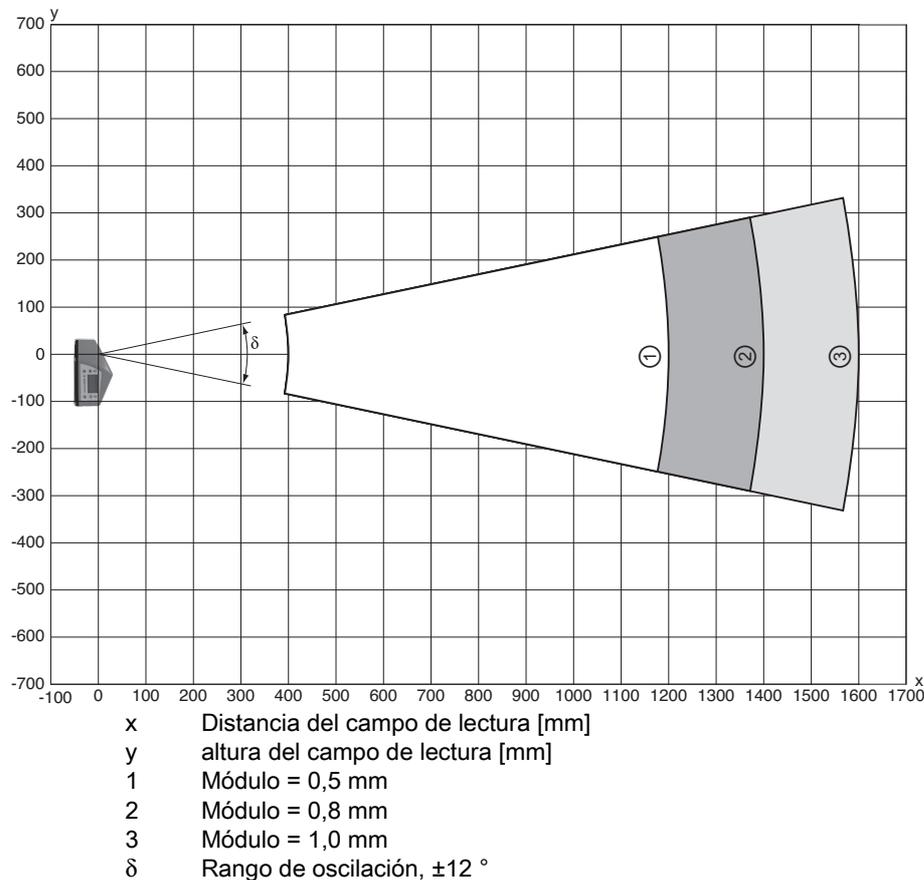
Fig. 15.28: Curva lateral del campo de lectura «Low Density» para escáner con espejo oscilante con calefacción
