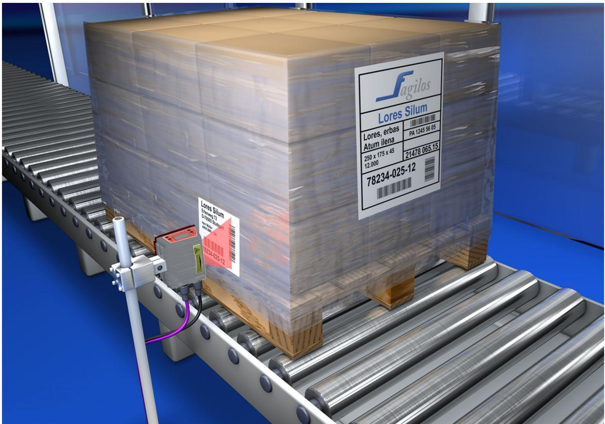
Fig. 5.1: Principio de barrido del escáner lineal
