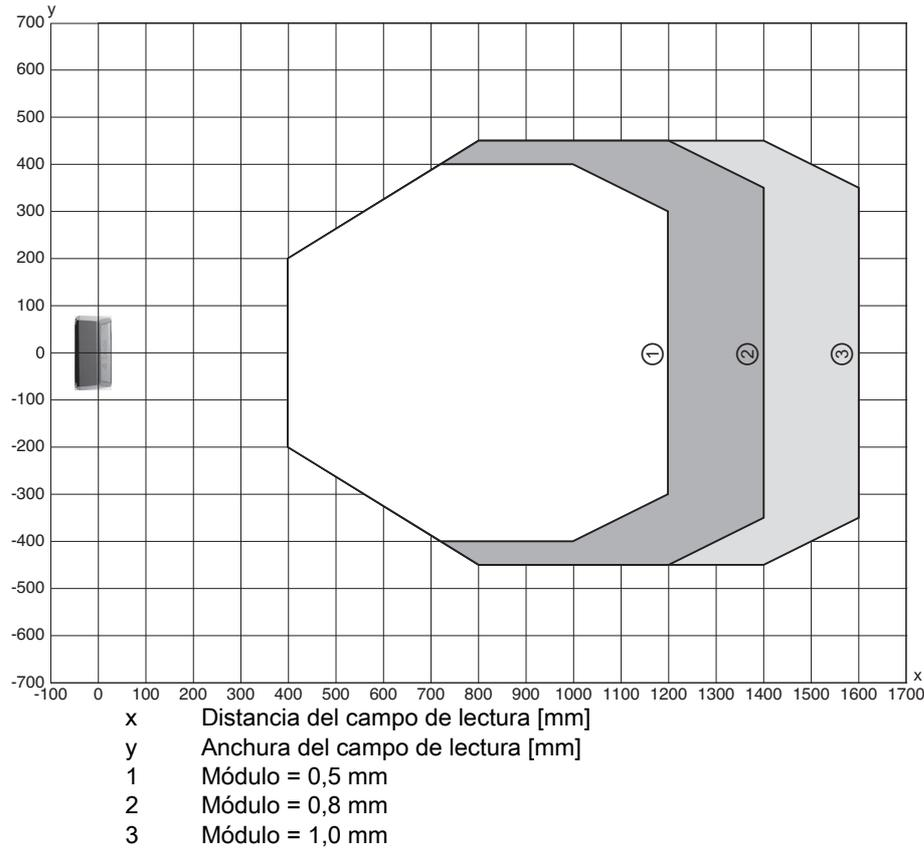
Fig. 15.27: Curva del campo de lectura «Low Density» para escáner con espejo oscilante con calefacción
