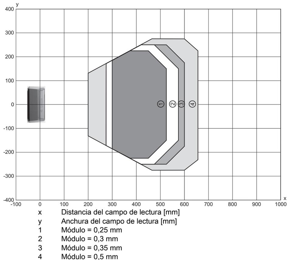
Fig. 15.21: Curva del campo de lectura «High Density» para escáner con espejo oscilante con calefacción
