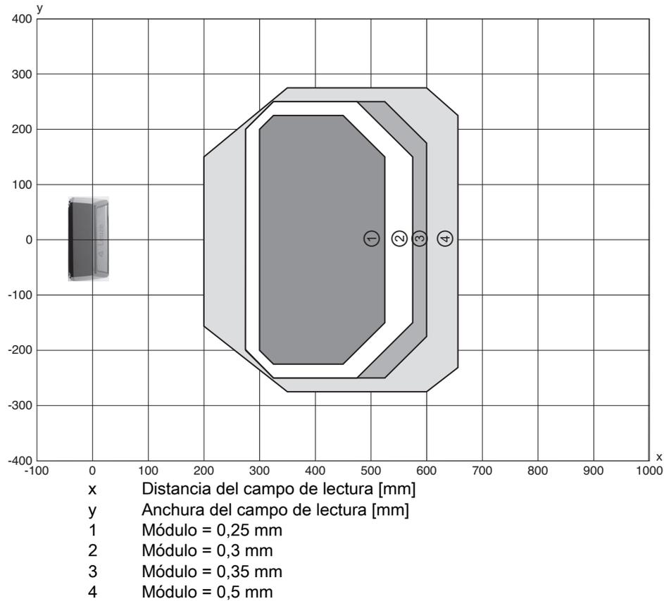
Fig. 15.9: Curva del campo de lectura «High Density» para escáner con espejo oscilante
