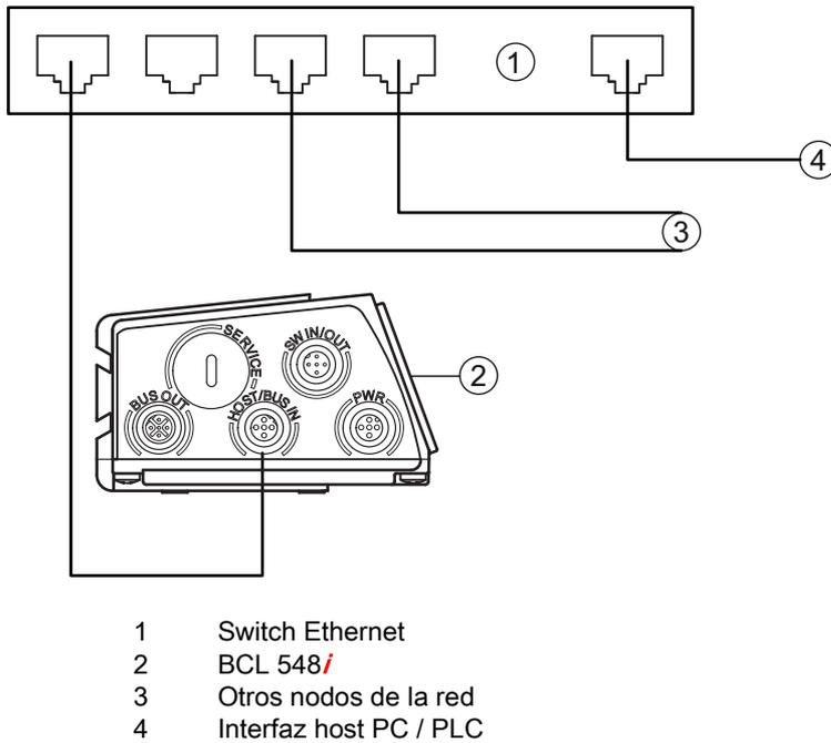
Fig. 7.13: PROFINET-IO en topología de estrella
