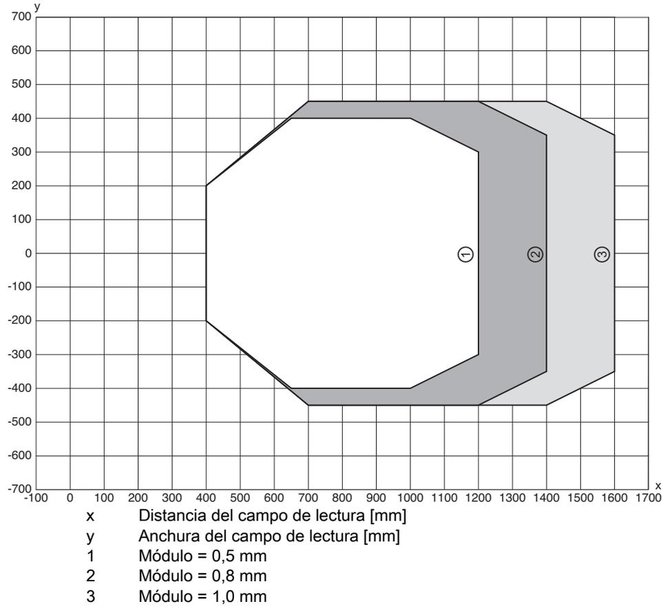
Fig. 15.14: Curva del campo de lectura «Low Density» para escáner lineal
