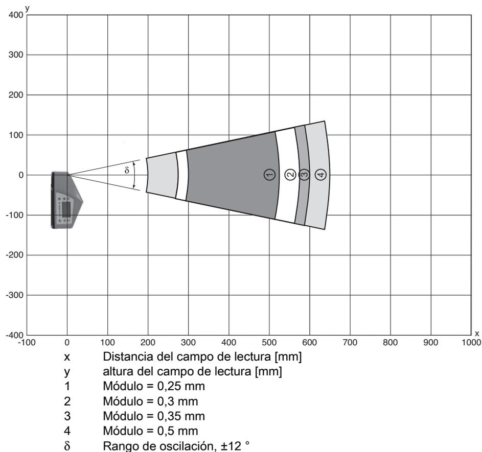
Fig. 15.22: Curva lateral del campo de lectura «High Density» para escáner con espejo oscilante con calefacción
