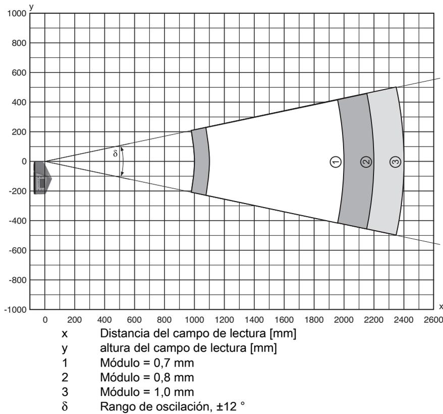
Fig. 15.31: Curva lateral del campo de lectura «Ultra Low Density» para escáner con espejo oscilante con calefacción
