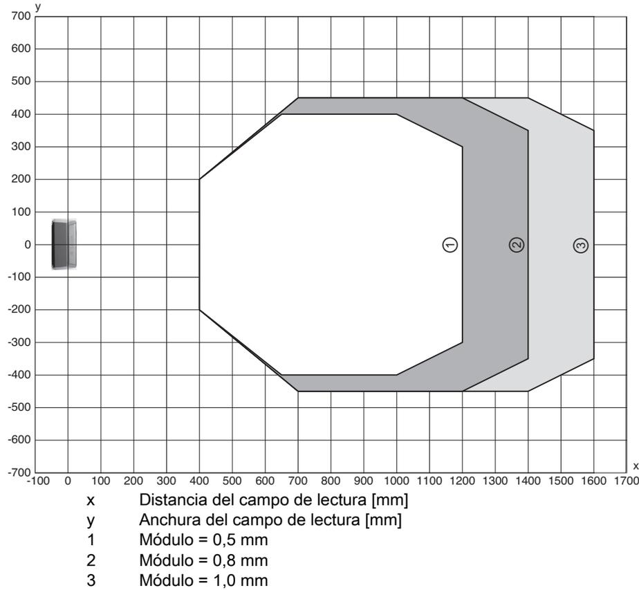
Fig. 15.15: Curva del campo de lectura «Low Density» para escáner con espejo oscilante
