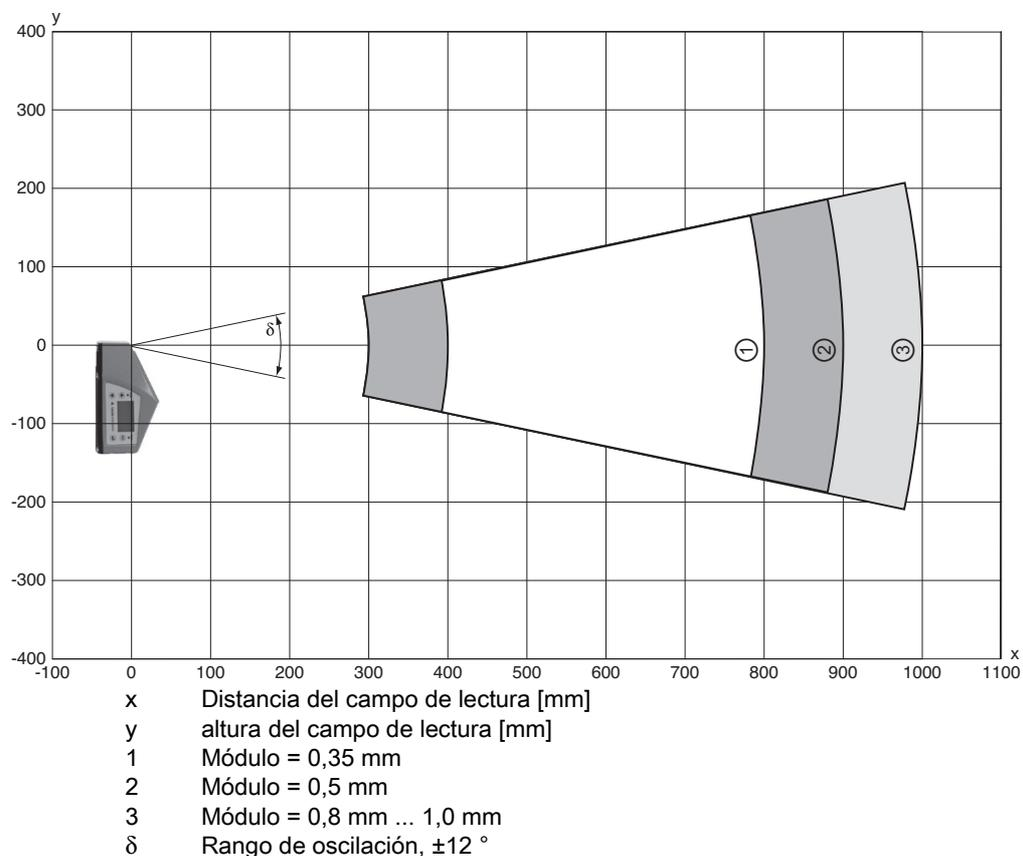
Fig. 15.25: Curva lateral del campo de lectura «Medium Density» para escáner con espejo oscilante con calefacción
