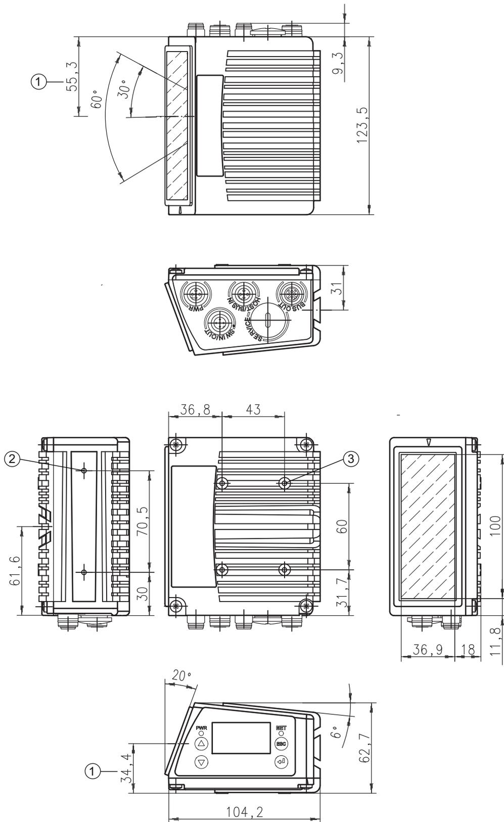
Fig. 15.1: Dibujo acotado del escáner lineal
