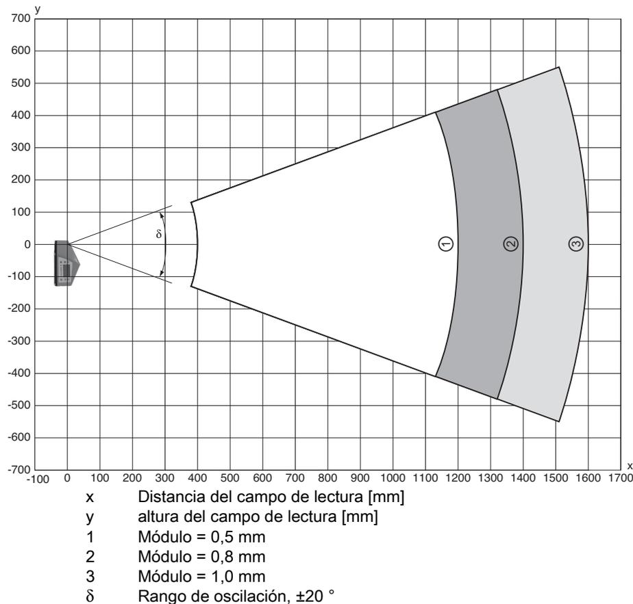
Fig. 15.16: Curva lateral del campo de lectura «Low Density» para escáner con espejo oscilante
