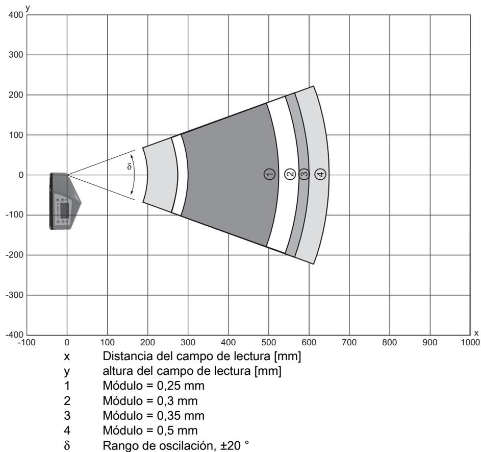
Fig. 15.10: Curva lateral del campo de lectura «High Density» para escáner con espejo oscilante
