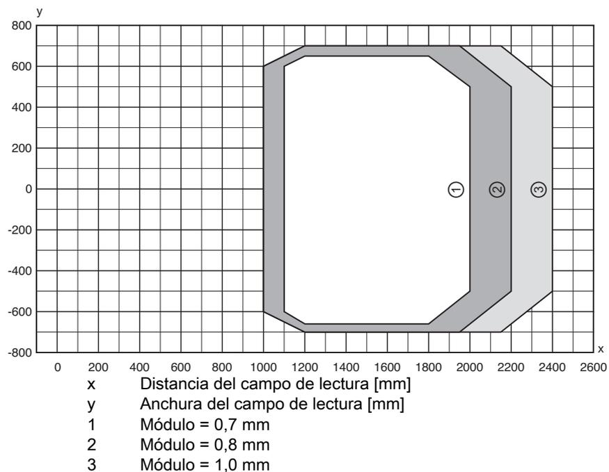
Fig. 15.17: Curva del campo de lectura «Ultra Low Density» para escáner lineal
