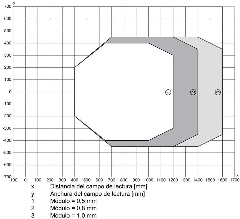
Fig. 15.26: Curva del campo de lectura «Low Density» para escáner lineal con calefacción
