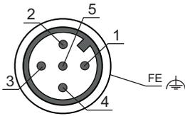
Fig. 7.3: PWR, conector M12 (codificación A)
