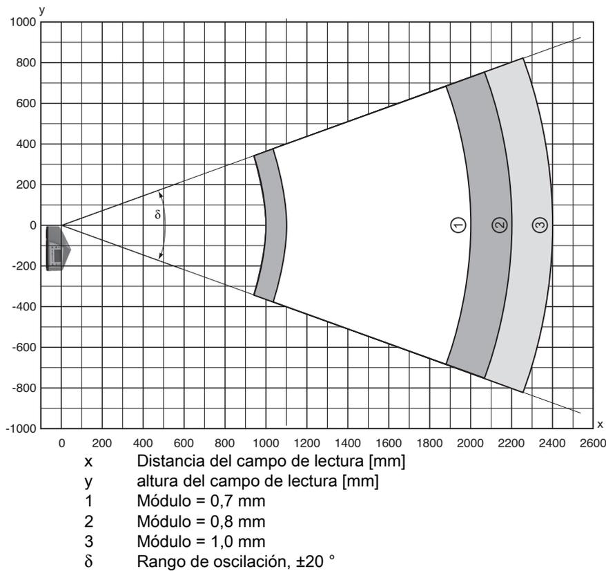
Fig. 15.19: Curva lateral del campo de lectura «Ultra Low Density» para escáner con espejo oscilante
