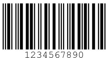
Fig. 17.9: Tipo de código 01: Interleaved 2 of 5
