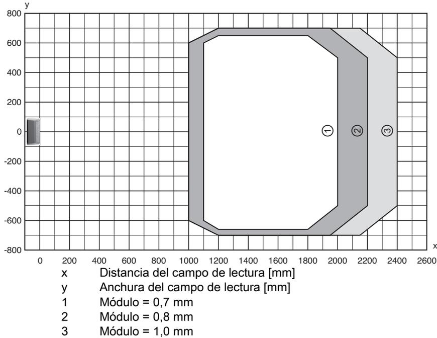
Fig. 15.18: Curva del campo de lectura «Ultra Low Density» para escáner con espejo oscilante
