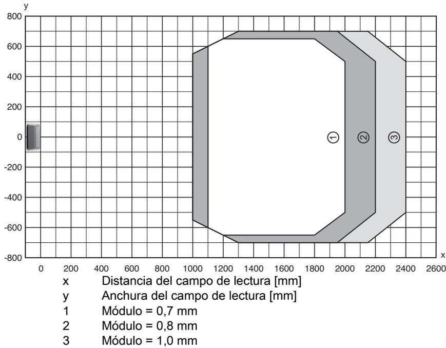
Fig. 15.30: Curva del campo de lectura «Ultra Low Density» para escáner con espejo oscilante con calefacción
