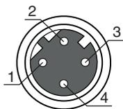
Fig. 7.10: Host/BUS IN, hembra M12 (codificación D)
