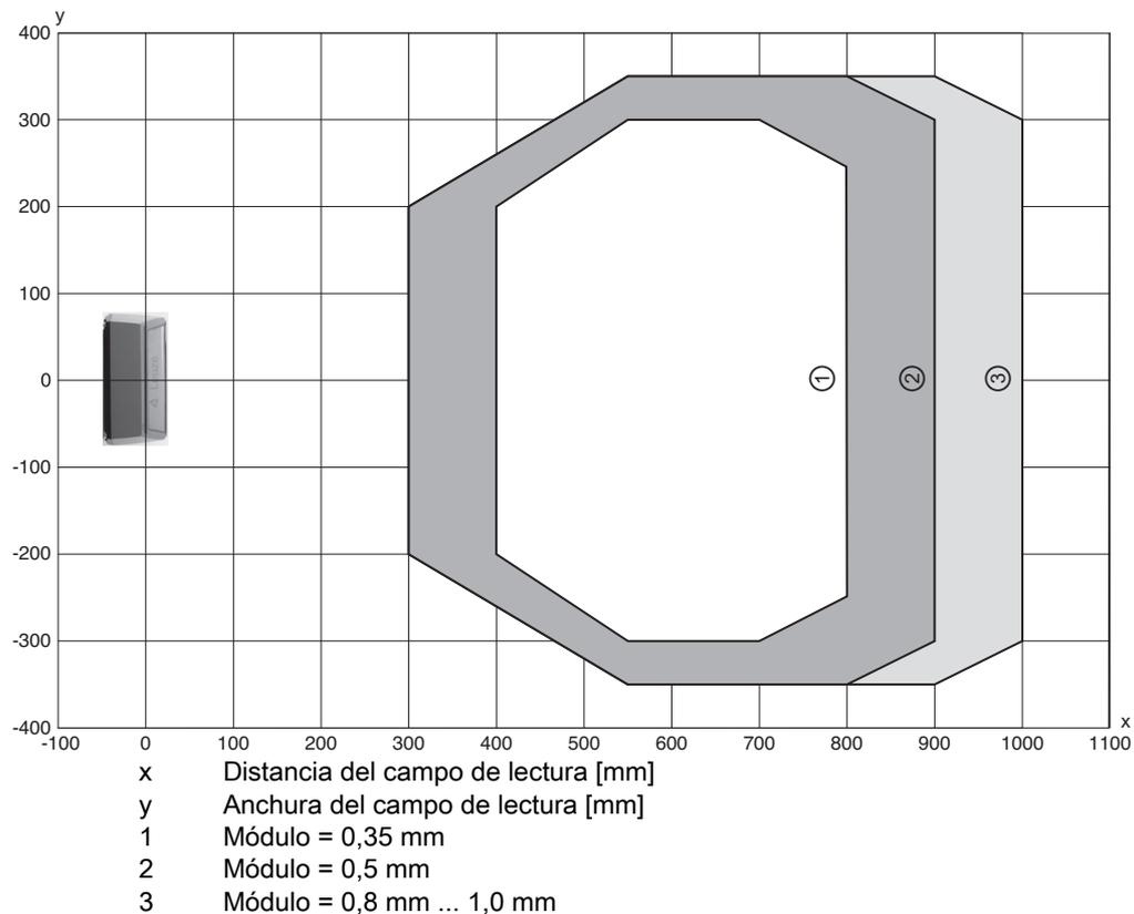
Fig. 15.12: Curva del campo de lectura «Medium Density» para escáner con espejo oscilante
