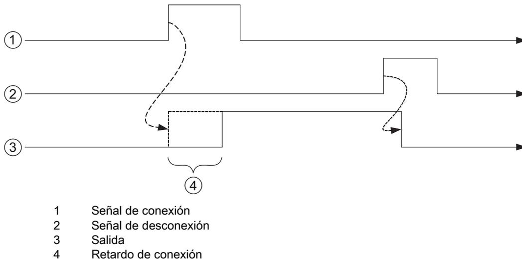
Fig. 10.5: Ejemplo 1: retardo de conexión > 0 y duración de la conexión = 0
