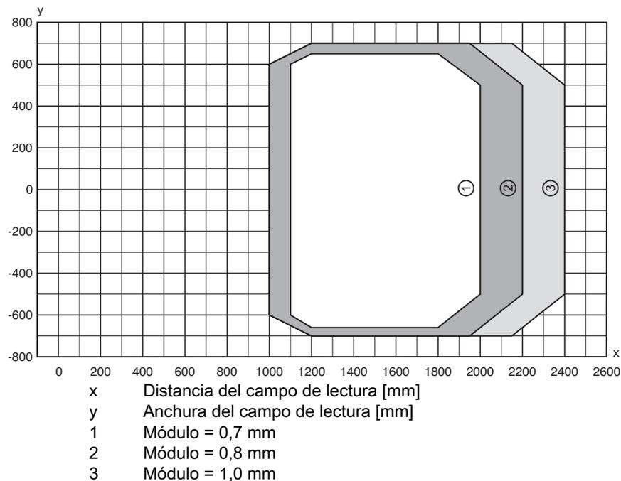
Fig. 15.29: Curva del campo de lectura «Ultra Low Density» para escáner lineal con calefacción
