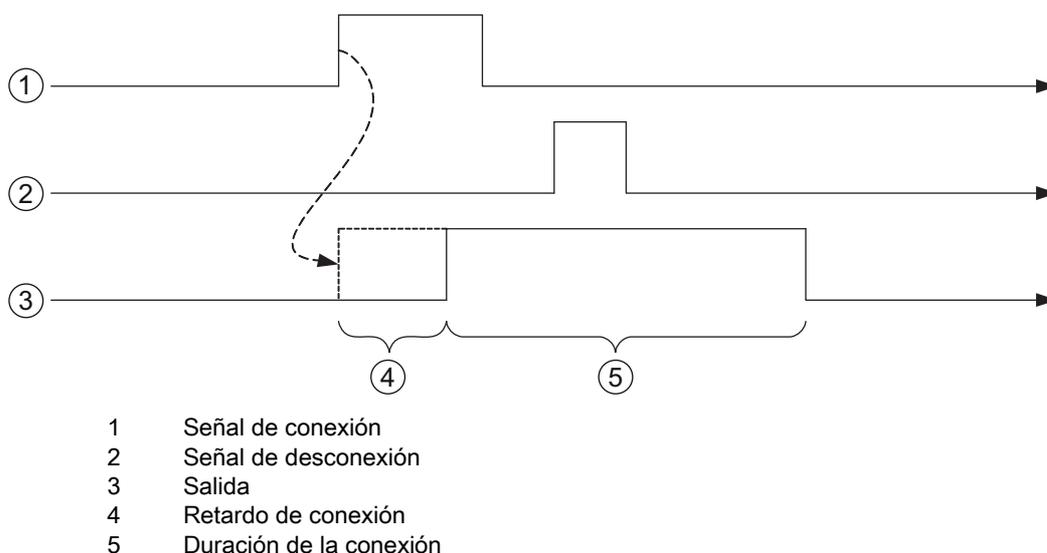
Fig. 10.6: Ejemplo 2: Retardo de conexión > 0 y duración de la conexión > 0
