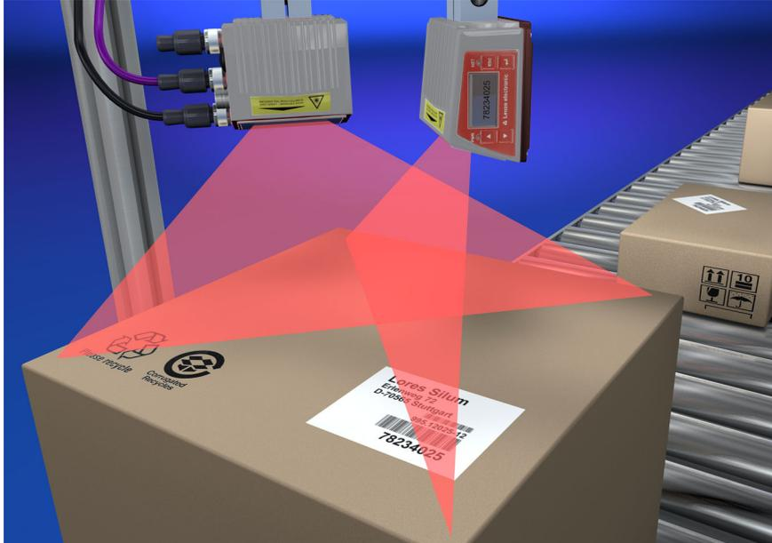
Fig. 5.3: Configuración esquemática para la lectura omnidireccional
