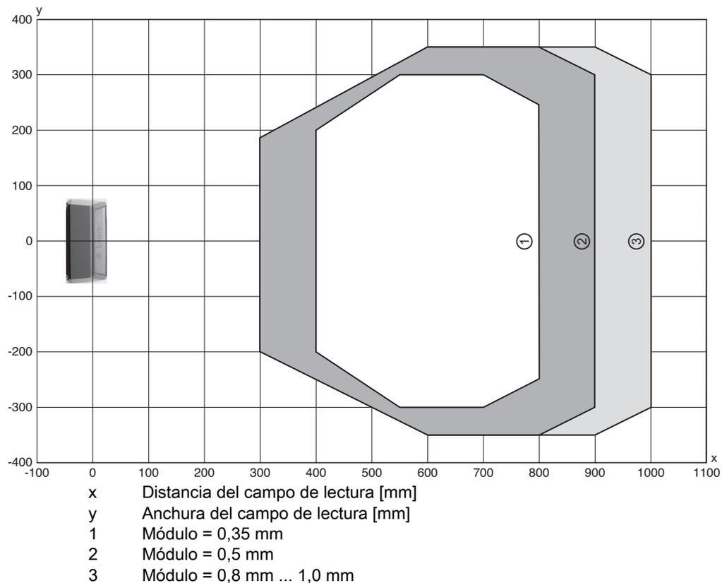
Fig. 15.24: Curva del campo de lectura «Medium Density» para escáner con espejo oscilante con calefacción
