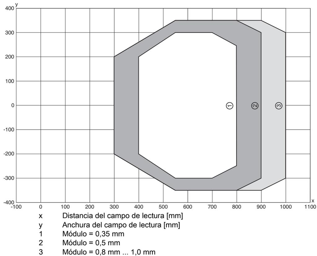
Fig. 15.11: Curva del campo de lectura «Medium Density» para escáner lineal
