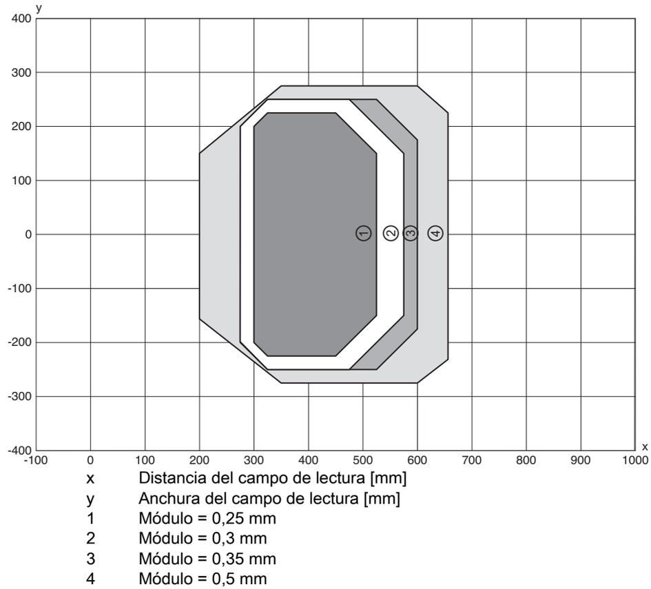
Fig. 15.8: Curva del campo de lectura «High Density» para escáner lineal
