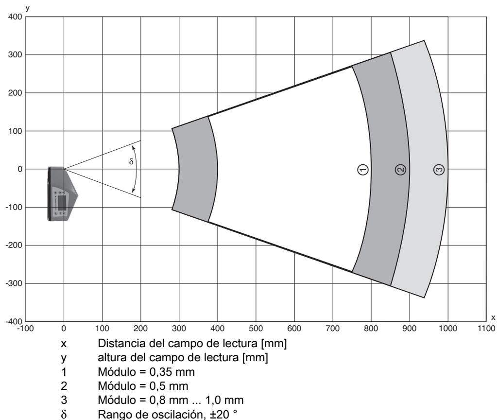
Fig. 15.13: Curva lateral del campo de lectura «Medium Density» para escáner con espejo oscilante
