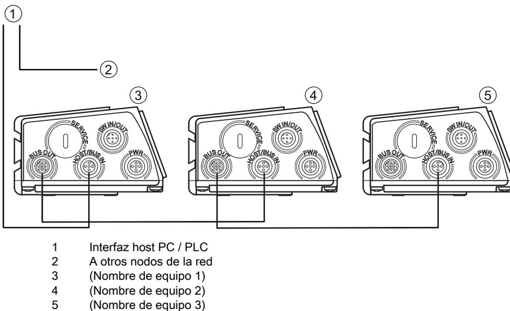
Fig. 7.14: PROFINET-IO en topología lineal
