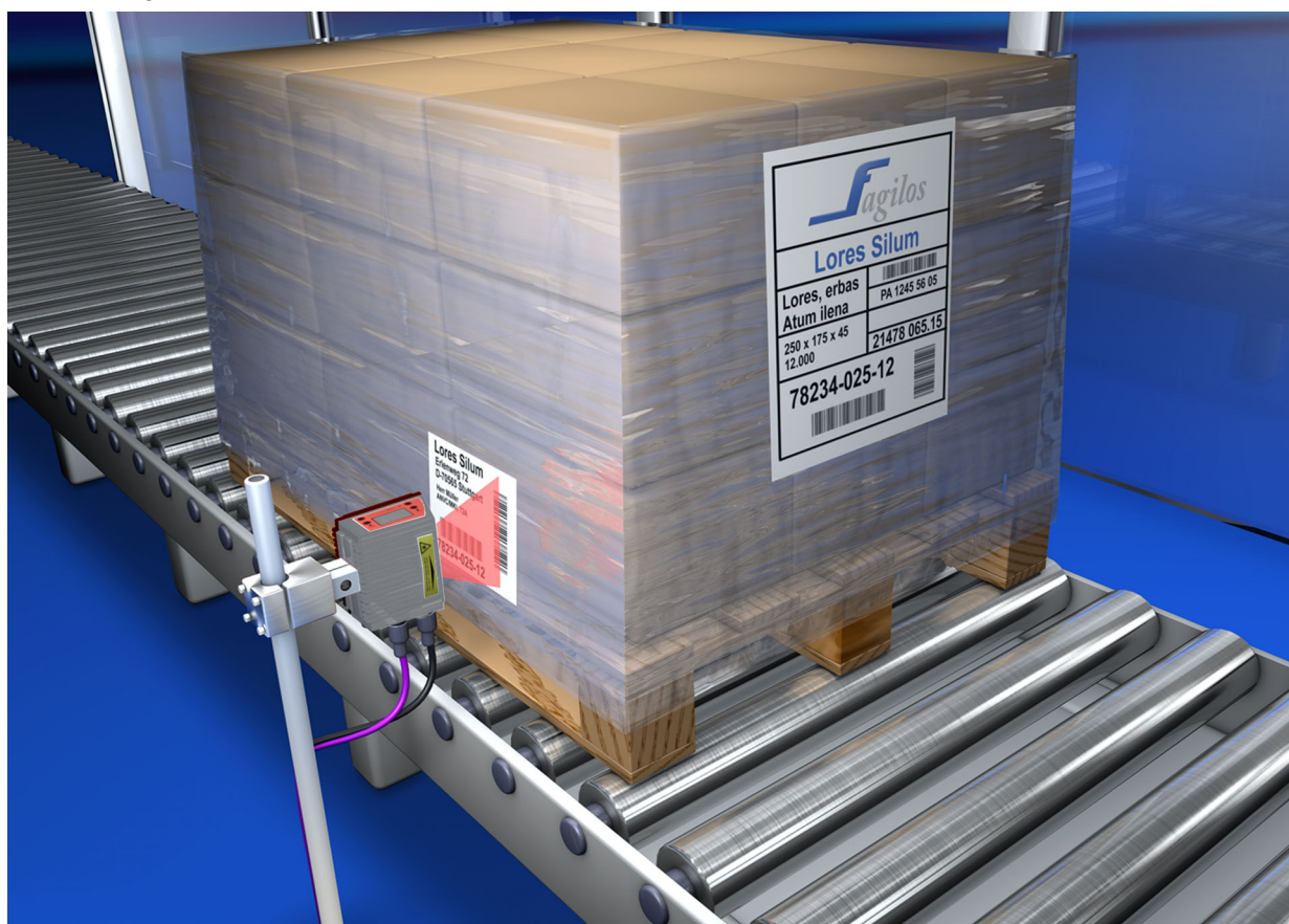
Figure 5.1 : Principe de déviation du scanner monotrame
