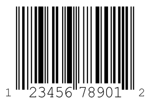
Figure 17.3 : Type de code 06 : UPC-A
