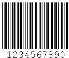
Figura 17.1: Tipo di codice 01: Interleaved 2 of 5
