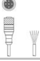
50132079 | KD U-M12-5A-V1-050 | 接続回線 | コネクタ 1: 丸形プラグ, M12, 軸方向, メス, A-符号化, 5-極<br>丸形プラグ、LED: いいえ<br>コネクタ 2: オープン末端<br>シールド: いいえ<br>ケーブル長: 5,000 mm<br>シースの素材: PVC |
