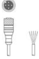
50132077 | KD U-M12-5A-V1-020 | 接続回線 | コネクタ 1: 丸形プラグ, M12, 軸方向, メス, A-符号化, 5-極<br>丸形プラグ、LED: いいえ<br>コネクタ 2: オープン末端<br>シールド: いいえ<br>ケーブル長: 2,000 mm<br>シースの素材: PVC |
