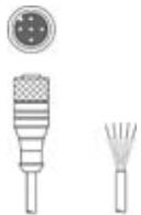
50133855 | KD S-M12-5A-V1-020 | 接続回線 | コネクタ 1: 丸形プラグ, M12, 軸方向, メス, A-符号化, 5-極<br>丸形プラグ、LED: いいえ<br>コネクタ 2: オープン末端<br>シールド: はい<br>ケーブル長: 2,000 mm<br>シースの素材: PVC  |
