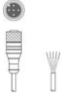
50133856 | KD S-M12-5A-V1-050 | 接続回線 | コネクタ 1: 丸形プラグ, M12, 軸方向, メス, A-符号化, 5-極<br>丸形プラグ、LED: いいえ<br>コネクタ 2: オープン末端<br>シールド: はい<br>ケーブル長: 5,000 mm<br>シースの素材: PVC  |
