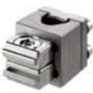
50121435 | BT 56 - 1   | Befestigungsteil | Funktionen: Statische Anwendungen<br>Ausführung des Befestigungsteils: Montagesystem<br>Befestigung, anlagenseitig: für Rundstange 12 mm, für Rundstange 14 mm, für Rundstange 16 mm<br>Befestigung, geräteseitig: klemmbar<br>Werkstoff: Metall<br>Anzugsdrehmoment der Klemmbacken: 8 N·m |
