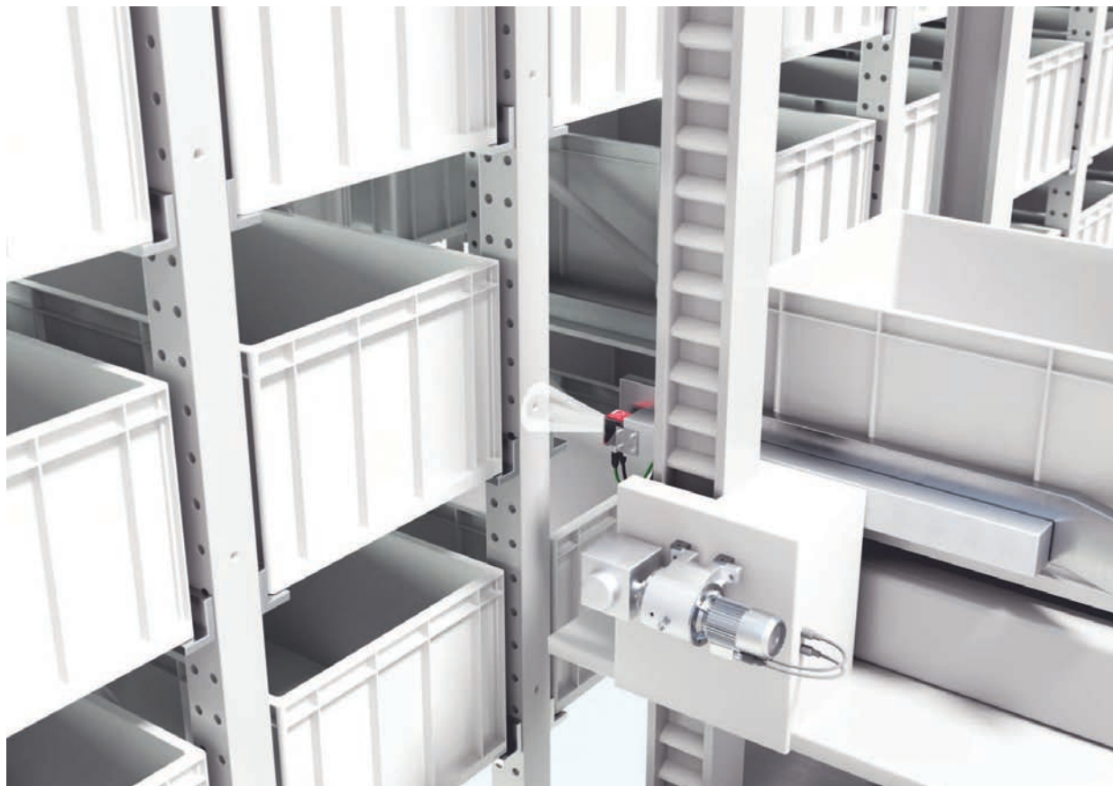
Figura 5.2: Posizionamento preciso delle forche telescopiche in un magazzino per contenitori di pezzi piccoli
