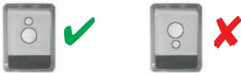
Figura 6.28: Orientación de la lámina difusora
